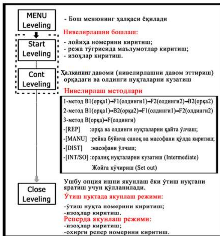
15.18-расм. DL-102 C TOPCON нивелирнинг Menu экрани
