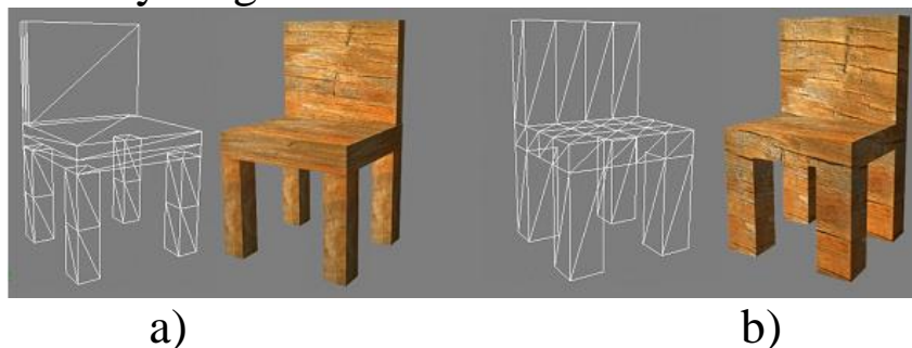
5.58-rasm. “Stul” obyektining xomaki nusxasini modellashtirish: a) Model oltita primitivdan tashkil topgan; b) Model poligonlarni tahrirlash orqali yaratilgan.
