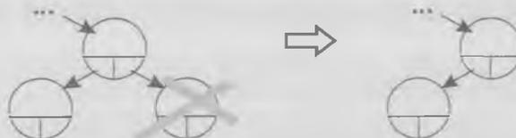
Рис. 9.1. Удаление узла, не имеющего потомков
