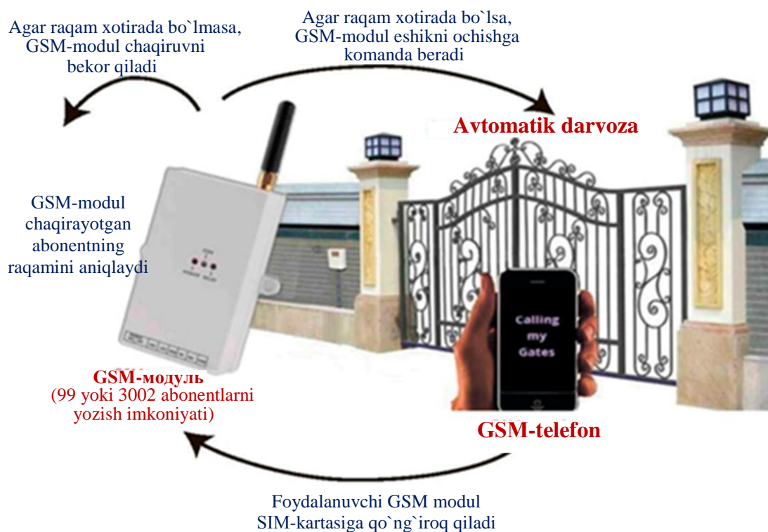
6.1- rasm. Darvozalarni ochish qurilmasinin ishlash tamoyili
