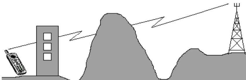
4.12- rasm. MS va BTS orasidagi radiosignalning tarqalishi yoʻlida vujudga keladigan toʻsiqlar
