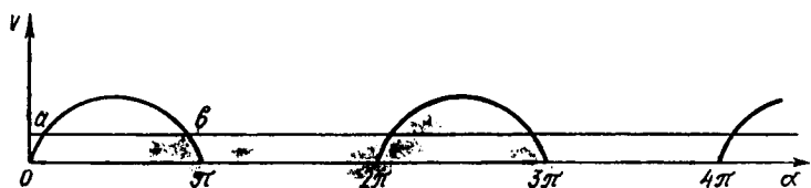
2.32- расм. Поршенли насосда сўришнинг нотекислигини кўрсатувчи схема.
