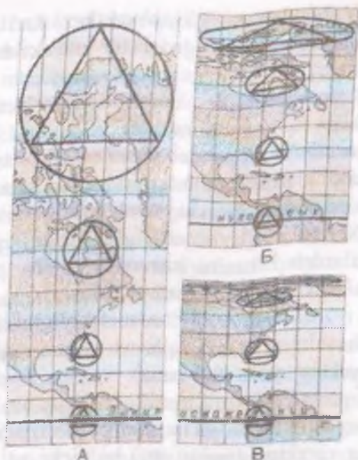
8.4-rasm. Slindrik proyeksiyalarda tuzilgan xaritalardagi xatoliklar ellipsi
