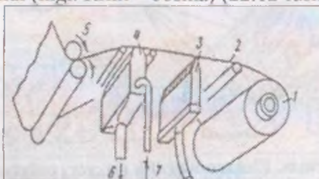
22.12-rasm. Elektrostatik bosma uskunaning ishlash chizmasi.
