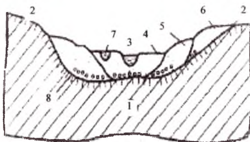
9.10-rasm. Daryo vodiysi tuzilishining elementlari: 1- tub jinslar; 2-yonbag'ir; 3-o'zan; 4-poyma-qayir; 5- poyma ustidagi birinchi terrasasi; 6- poyma ustidagi ikkinchi terrasasi; 7- eski o'zan; 8- vodiy tubi.
