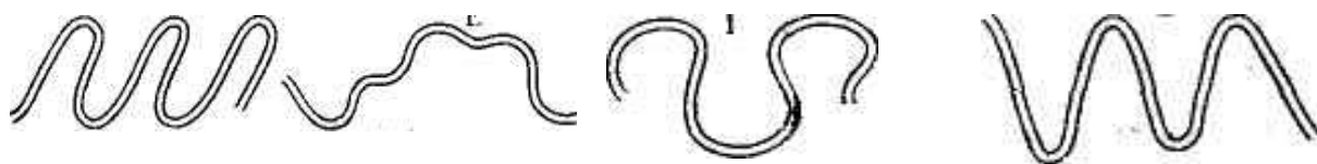
Рис. 7. Элементы излучин: L — шаг излучины; g — радиус излучины; h — стрела прогиба; B — ширина пояса меандрирования; b — ширина русла
