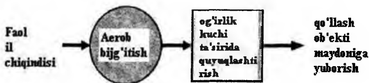
61-rasm. Oqava suvlarni tozalash korxonalarida (WWTs) ilni qayta ishlash ketma-ketligi.
