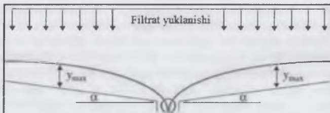
101-rasm. Poligon drenaj tizimining sxemasi.
