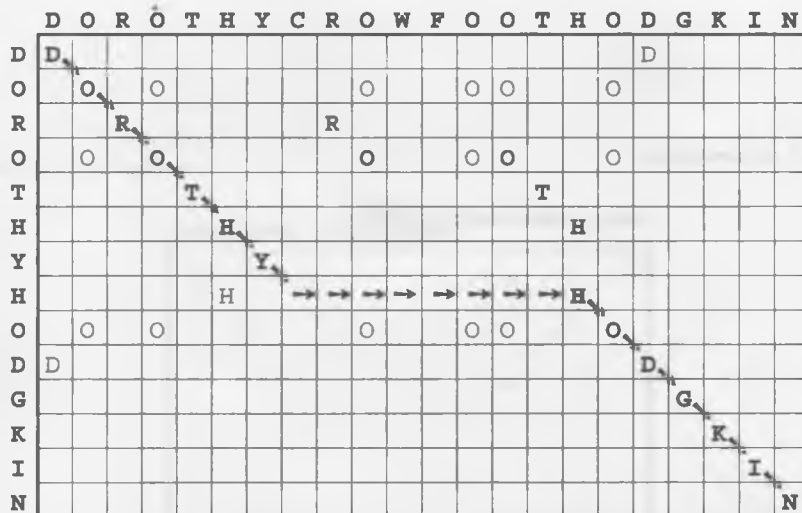
Рис. 4.1. Любой путь по точечной матрице от верхнего левого угла к нижнему правому проходит последовательность ячеек, каждая из которых предсказывает пару позиций: одну из ряда и одну из столбца, которые совпадают с выравниванием; либо означают пробел в одной из последовательностей. Путь не обязательно должен проходить лишь заполненные позиции. Тем не менее, чем больше заполненных позиций, на диагональном отрезке пути, тем больше совпадающих остатков в выравнивании
